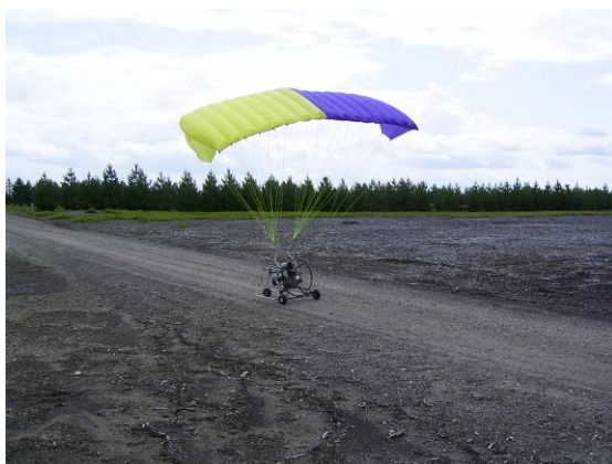
Figure 1. À gauche, le PIXY, un aéronef radiocommandé développé pour la prise d'images à basse altitude. À droite, le montage du réflex numérique commercial sur le PIXY.
