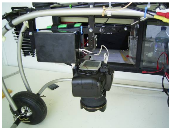
Figure 1. À gauche, le PIXY, un aéronef radiocommandé développé pour la prise d'images à basse altitude. À droite, le montage du réflex numérique commercial sur le PIXY.
